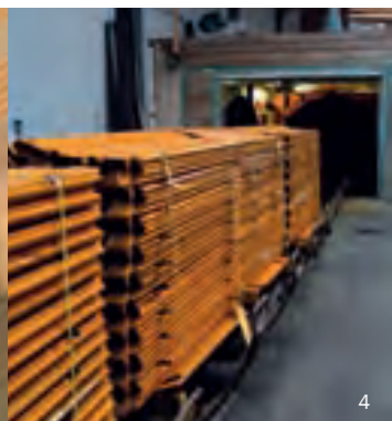
(3) Bordi con placchette di collegamento - (4) Trattamento in autoclave sotto la nostra supervisione
